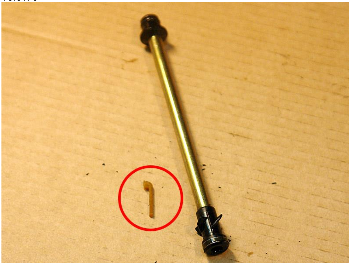
Фото №7: Посторонний предмет (кусочек пластика) найденный в трубке питания сцепления движения вперед.
